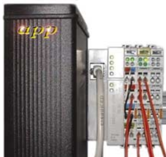
Die Steuerungszentrale app mit einem I/O-Kanal der Firma WAGO. Wenn gewünscht, können auch Ethernet-I/O-Komponenten der Fa. Beckhoff eingesetzt werden. Wenn erforderlich, können die I/O-Klemmen über Ethernet, Lichtleiter oder Funk einige Meter bis einige Kilometer ans app entfernt angeschlossen werden.
